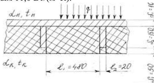
4. Определить коэффициент теплоотдачи ограждения, представленного на рисунке. Коэффициенты теплоотдачи к наружной и внутренней поверхностям принять равными  $11,6 \text{ Вт}/(\text{м}^2 \cdot \text{К})$
